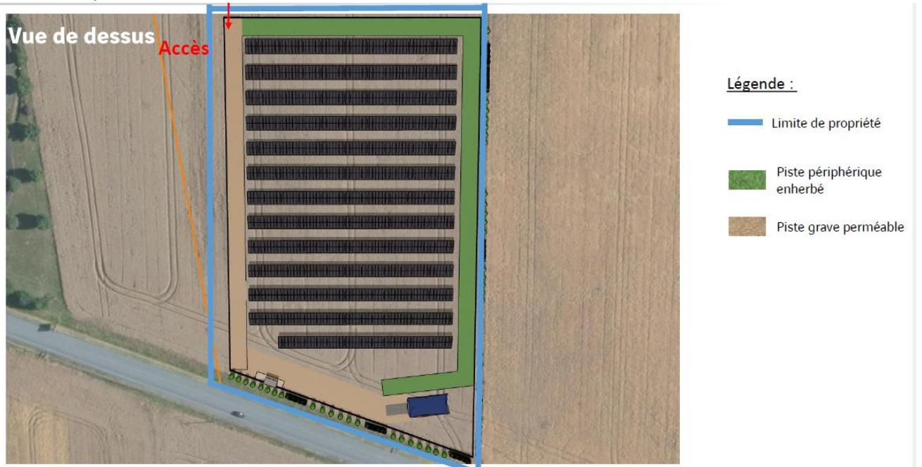
*Le projet consiste en la construction d'un parc de production d'électricité photovoltaïque au sol d'une puissance de 996,3 kWc. La surface d'emprise du projet est d'environ 1,4 hectare. La surface couverte par les modules photovoltaïques sera de 4252 m<sup>2</sup> (0,42 hectare). L'espacement entre les structures métalliques sera de 4 mètres. Le point bas de la structure sera à 1,10m et le point haut à 2,77m maximum.*
